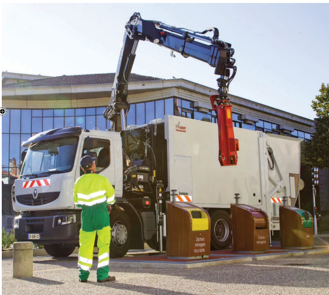
Opération de vidage des containers enterrés.
