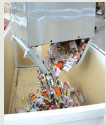
Les conteneurs enterrés sont adaptés pour la collecte en centre-ville. Ils sont peu encombrants, esthétiques, accessibles 24h/24, faciles d'entretien et ils nécessitent peu de passages de camions.
