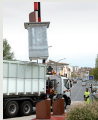
Les conteneurs enterrés sont adaptés pour la collecte en centre-ville. Ils sont peu encombrants, esthétiques, accessibles 24h/24, faciles d'entretien et ils nécessitent peu de passages de camions.
